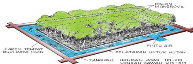
Gambar 1. Silvofishery model empang parit (Bengen 2000)
