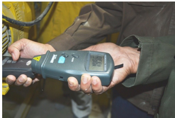
Gambar 1. Pengukuran putaran dan kebisingan Motor Screw
