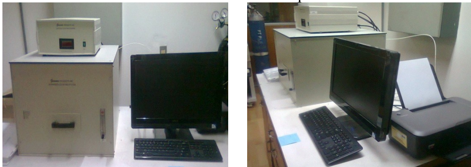
Gambar.2 Alat Alpha Beta Counter G520 siap diuji fungsikan
