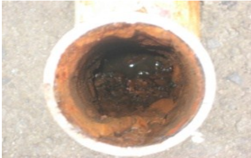
Gambar 2. Potongan pipa ruang binatu
