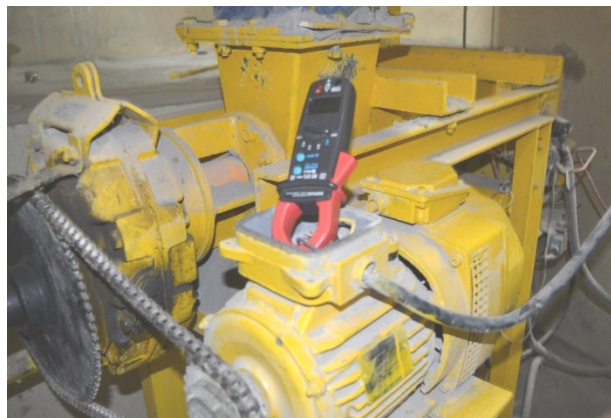
Gambar 2. Pengukuran Ampere motor screw dalam perawatan preventif
