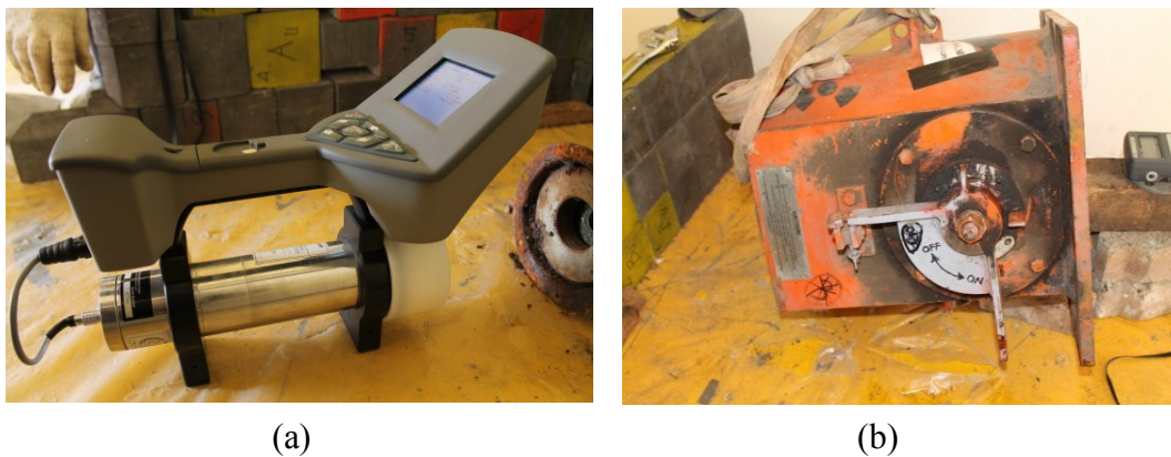
Gambar 5. Identifikasi jenis radionuklida menggunakan spektrometer gamma portable BNC 940 (a), dan mengukur laju paparan radiasi menggunakan surveimeter FAG (b).
