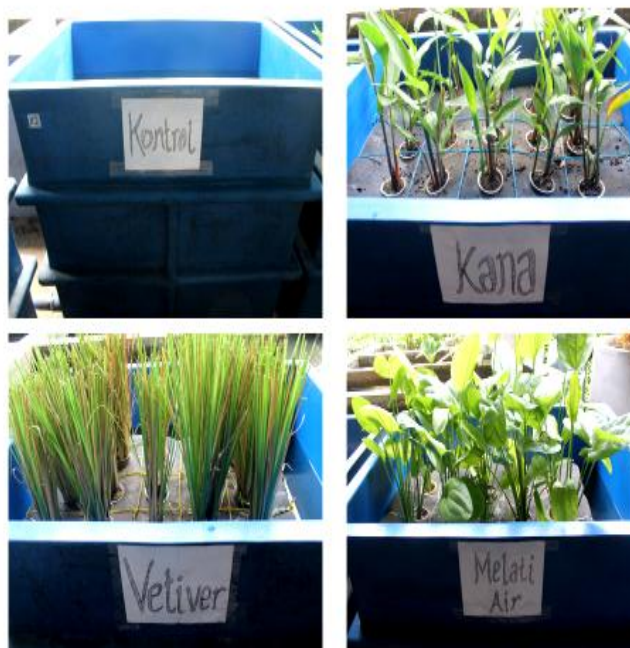
Gambar 1. Sistem Floating Treatment Wetlands (FTW's) Skala Lab pada Bak-Bak Percobaan
