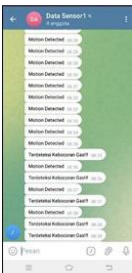
Gambar 8. Tampilan Notifikasi Telegram Status Bahaya Pada Sensor PIR
