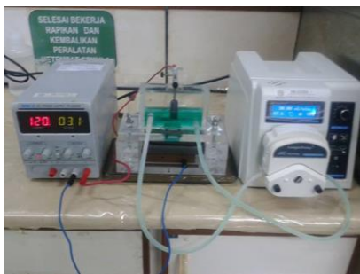
Gambar 1. Rangkaian proses elektroplating
