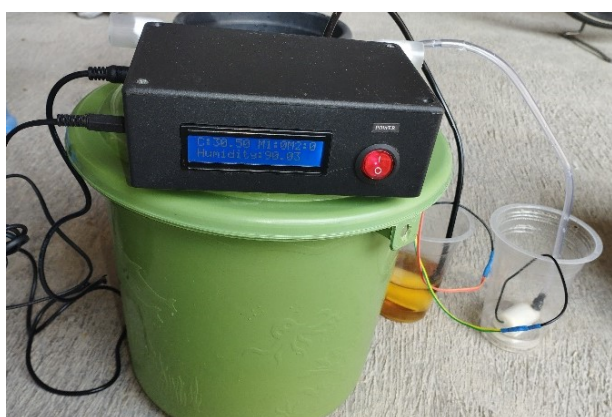
Gambar 8. Hasil Akhir Sistem Pengolah Limbah Rumah Tangga menjadi Kompos berbasis Mikrokontroler
