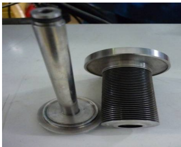
Gambar 12a. Valve bellow yang rusak/sobek
