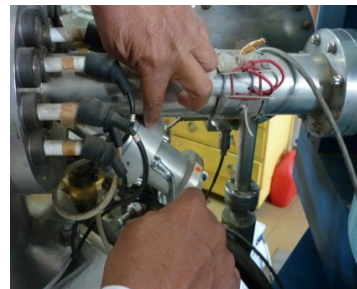
Gambar 12c. Pemasangan valve bellow yang baru
