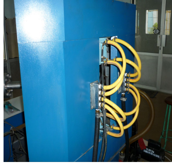
Gambar 4b. Saluran air dari chiller untuk pendingin magnet (kuning input , hitam output )
