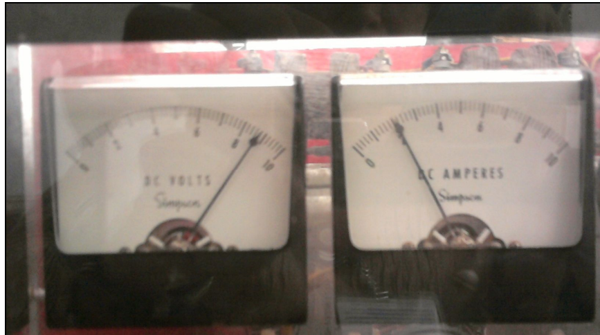
Gambar 17a. Filamen pinggir (kiri) pada tegangan 8.8 V dan arus 2 A
