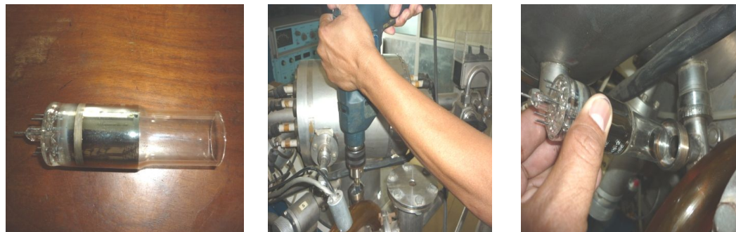
Gambar 10. Perbaikan ion tube GIC-048-2
