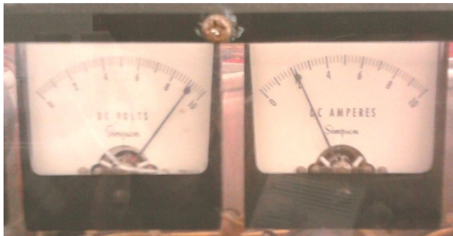
Gambar 17b. Filamen tengah pada tegangan 9.1 V dan arus 2.2 A
