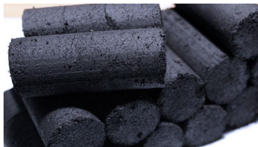
Gambar 7. Biobriket dari limbah kulit kopi [26]
