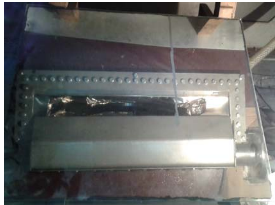
Gambar 7b. Jendela Ti yang rusak karena berkas elektron yang sudah dilepas dari MBE.
