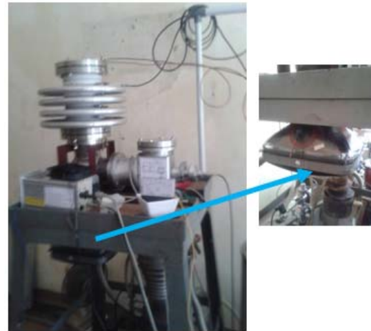
Gambar 3. Instalasi sensor profil berkas pada sistem sumber elektron.
