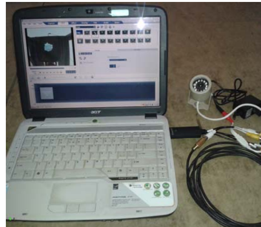
Gambar 4. Koneksi CCTV dan Laptop menggunakan video adaptor Easy Caputer USB.2.0.
