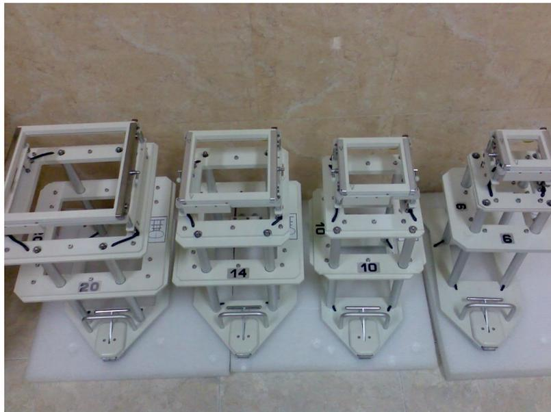
**Gambar 3. Empat buah aplikator pembentuk lapangan radiasi berkas elektron dari pesawat pemercepat linier medik Elekta 151614, masing-masing aplikator 6 cm x 6 cm, 10 cm x 10 cm, 14 cm x 14 cm dan 20 cm x 20 cm**
