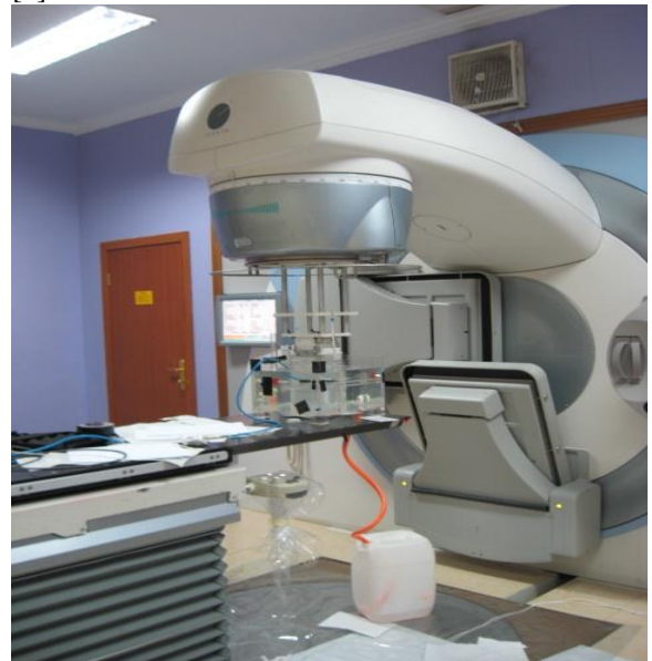
Gambar 2. Pengukuran muatan pada berkas radiasi elektron energi 6 MeV pesawat Linac
