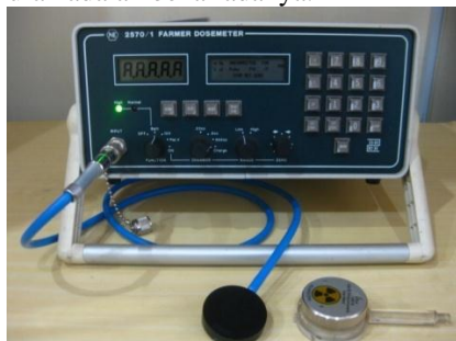
Gambar 1. Pengecekan stabilitas alat ukur radiasi Farmer dan detektor ionisasi Roos
