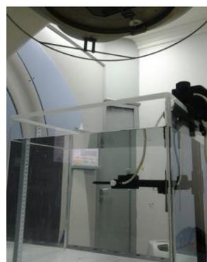
**Gambar 3.** Susunan peralatan pada pengukuran berkas foton 6 MV. Detektor diletakkan di dalam fantom air pada kedalaman 10 cm, jarak sumber radiasi ke permukaan air 100 cm dan lapangan radiasi pada permukaan air 10 cm x 10 cm.
