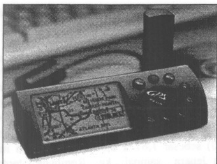
Gambar 3. Alat pemantau koordinat titik lokasi pengambilan contoh dengan menggunakan GPS III Plus, buatan Garmin Corporation [6].
