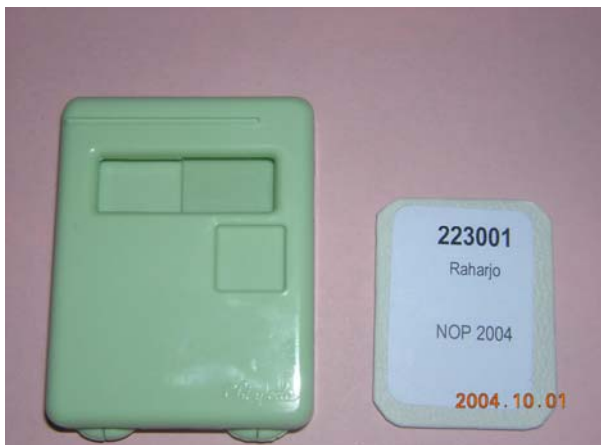
(a). Holder dan dosimeter film.
