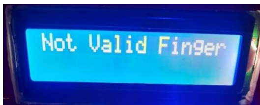
Gambar 14. Tampilan lcd ketika sensor membaca sidik jari yang tidak tersimpan
