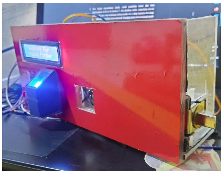
Gambar 4. Prototype sistem pengunci pintu otomatis berbasis arduino menggunakan sensor fingerprint
