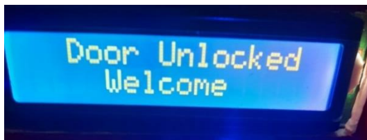
Gambar 12. Tampilan lcd ketika sensor membaca sidik jari yang tersimpan
