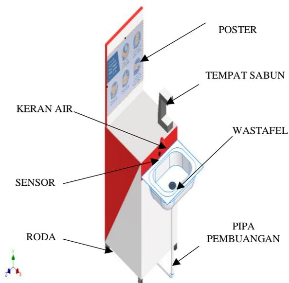
Gambar 2. Tampak desain isometri cuci tangan otomatis
