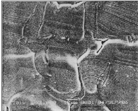
Gambar 4. Morfologi permukaan paduan bahan \text{CuIn}(\text{Se}_{0,2},\text{S}_{0,8})_2 dengan SEM (perbesaran 1.000 kali).
