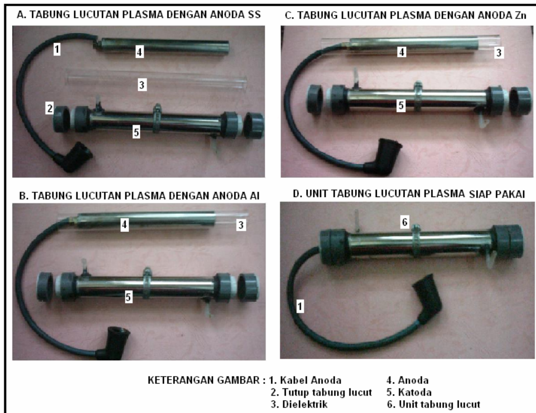
Gambar 2. Tabung lucutan plasma diskrit dengan anoda dari bahan SS, Al dan Zn.
