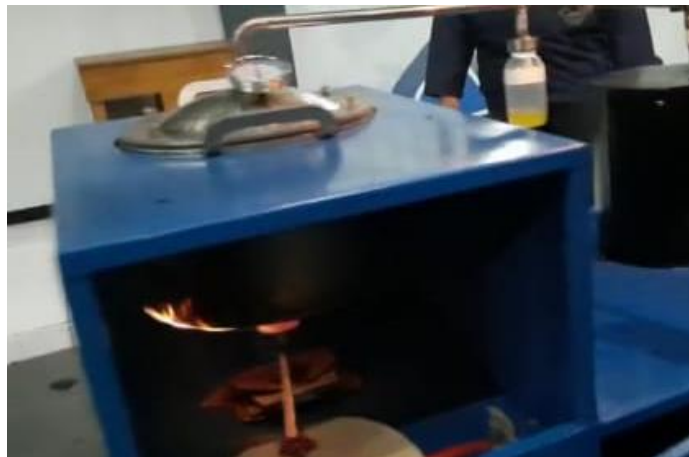
Gambar 6. Uji coba api hasil gas buang pada pembakaran pirolisis
