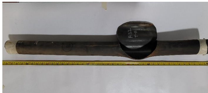
Gambar 1. Tube yang mengalami kebocoran
