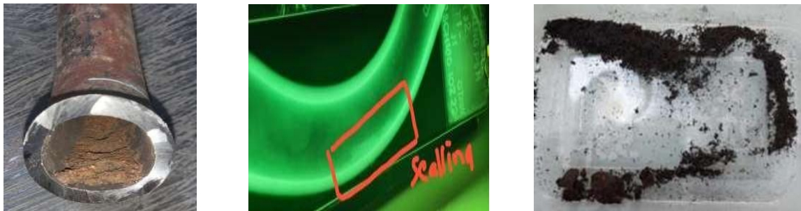
a. Deposit pada elbow sisi in b. Hasil radiografi pada elbow menunjukkan deposit pada dinding dalam tube c. Serbuk deposit
