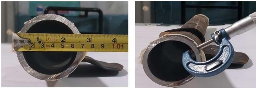
Gambar 3. Lokasi pengukuran ketebalan area bocor.
