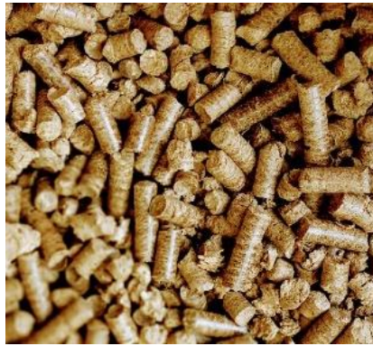
Gambar 8. Contoh Pelet Kayu sebagai Pengganti Kayu Bakar
