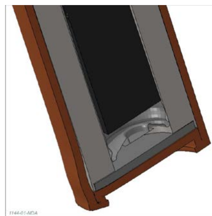
Gambar 4. Prediksi perubahan setelah terkena dampak kecelakaan dari penampang melintang tipe tabung disposal (suatu tabung disposal HLW) dijatuhkan dari ketinggian 8 meter [1].
