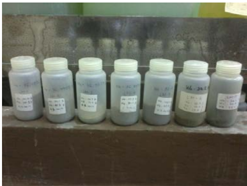
Gambar 3. Padatan hasil pengolahan limbah metalografi
