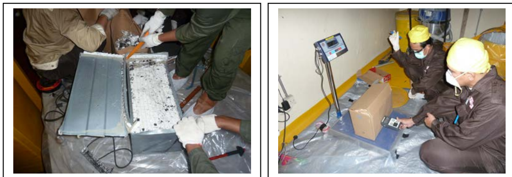
Gambar 3. Filter ukuran 30x30x60 cm dengan cassing terbuat dari plat galvanis dan limbah filter yang sudah dikemas dalam kardus sedang dilakukan analisis
