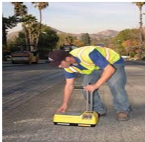
Gambar 2. Pekerja Menggunakan Alat Moisture/Density Gauge .
