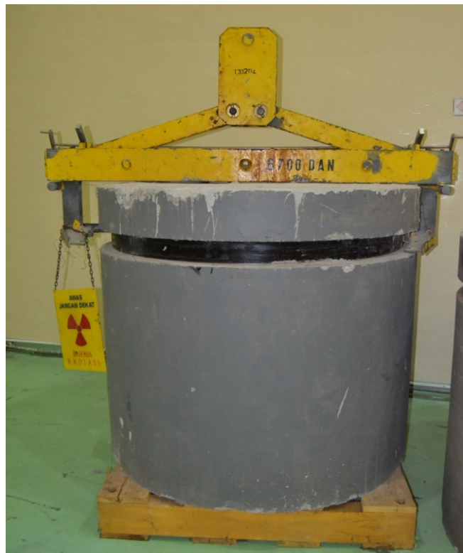
Gambar 3. Shell beton 950 l hasil olahan limbah resin bekas
