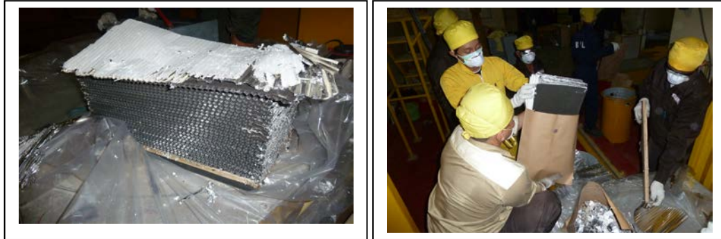
Gambar 2. Proses pewadahan filter dalam kantong kertas
