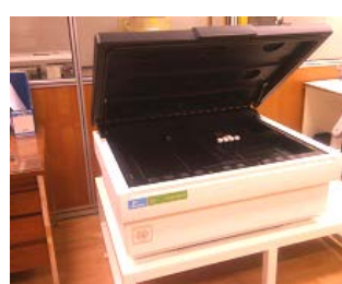
Gambar 3. Vial standar dan sampel dalam rak, serta pencacah LSC TRICARB 2910TR.
