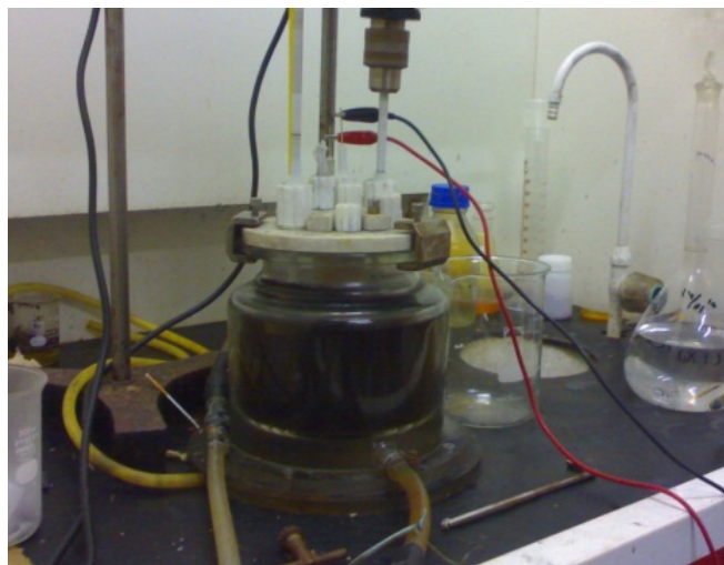
Gambar 2. Larutan oksidator \text{Ag}^{+2} hasil pembangkitan sel elektrokimia
