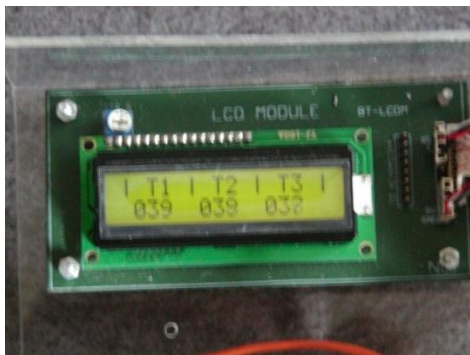
Gambar 6. Sistem penampil suhu bahan bakar reaktor kartini
