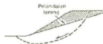
konsep keseimbangan plastis batas (*limit plastic equilibrium*). Maksud dari analisis stabilitas adalah untuk menentukan faktor aman dari bidang longsor yang potensial. Tipe keruntuhan lereng yang terjadi pada analisis yaitu tipe keruntuhan gabungan yang digambarkan pada Gambar 1 sebagai berikut.
