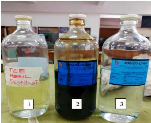
Gambar 3. Hasil penyulingan limbah praktikum kelarutan aspal + TCE
