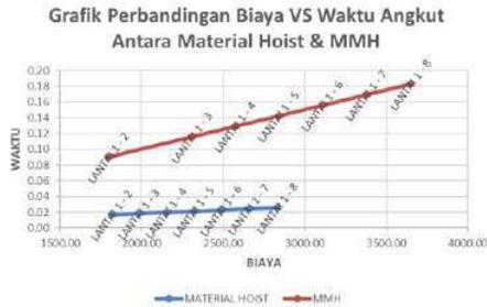
Gambar 5 Hubungan antara Biaya dan Waktu Menggunakan *Material Hoist* dan *Manual Material Handling*
