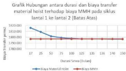
Gambar 6 Grafik hubungan antara durasi dan biaya material hoist dalam kondisi murah daripada MMH siklus lantai 1 ke lantai 2
