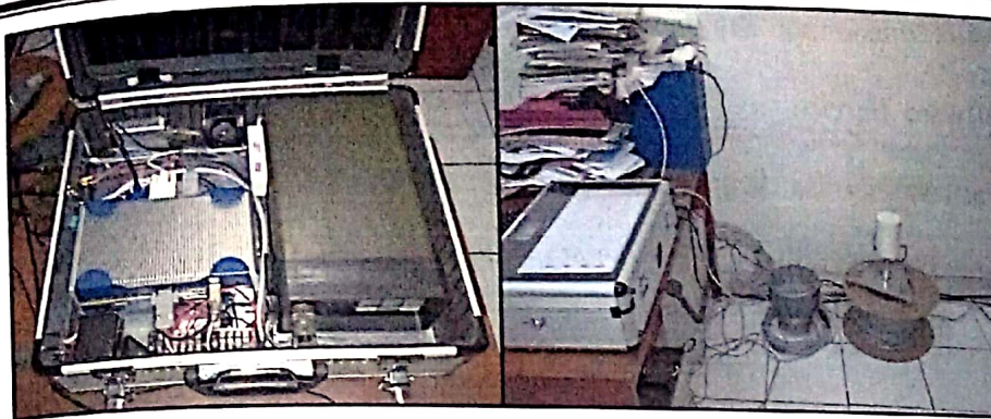
Gambar 3. Peralatan - peralatan untuk Sistem Observasi Geomagnet Terpadu – LAPAN yang telah diintegrasikan dan dikemas kedalam sebuah kotak jinjing.
