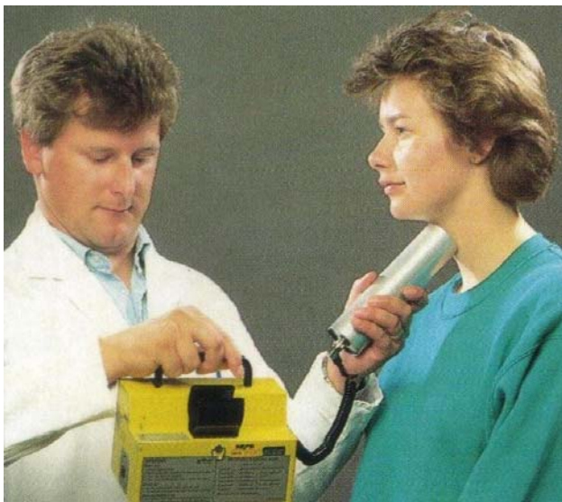
Gambar 2. Pemonitoran kelenjar tiroid untuk mengetahui kontaminasi interna oleh iod Radioaktif menggunakan detektor sinar gamma.
