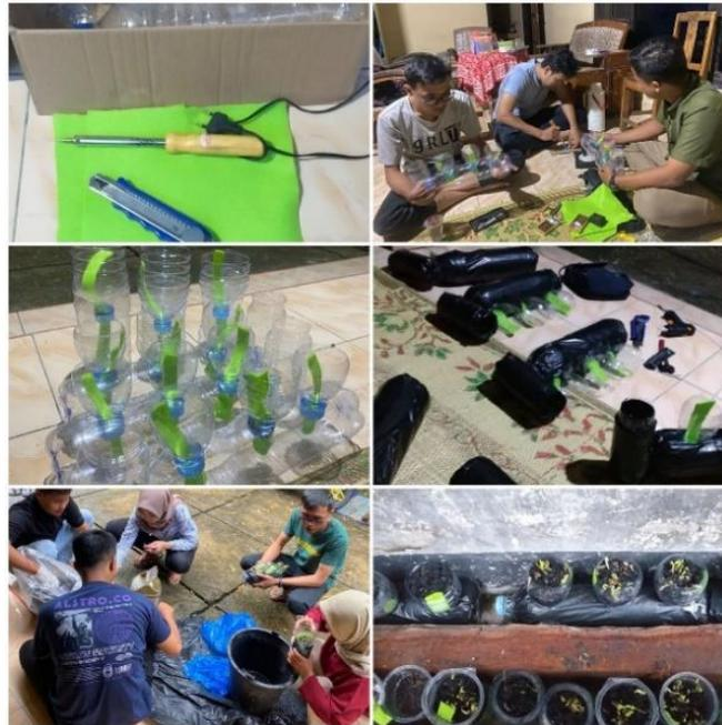
**Gambar 6. Persiapan alat, bahan dan proses pembuatan Hidroponik dari botol mineral bekas**
