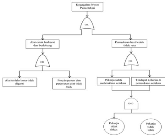
Gambar 1. Fault Tree Analysis Proses Pencetakan
