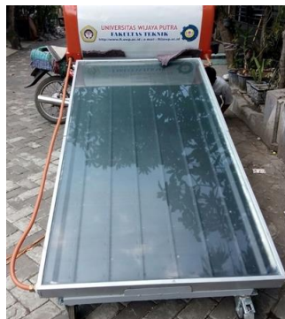
Gambar 2. Pemanas air tenaga surya
