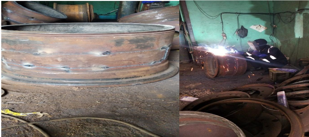
Gambar 7. Body velg tambahan pipa dan welding.
