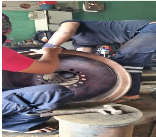
Gambar 11. Penyetingan penempatan kepala ke body velg.
