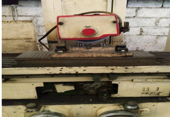
Gambar 4. Proses Penggrindingan Punch
