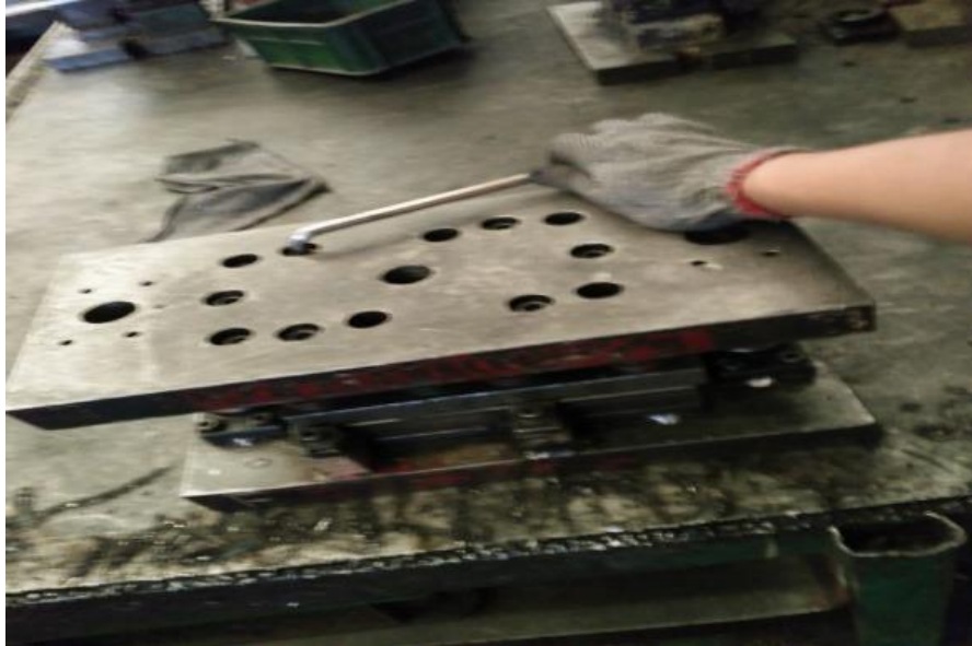
Gambar 2. Proses pembukaan bolt upper plate
