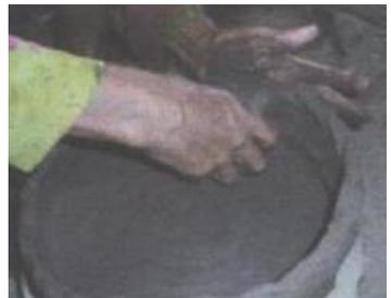
5. Permukaan luar badan benda keramik diratakan menggunakan *scraper* atau *potter rib*. tahapan ini adalah pembentukan lanjutan dari pembentukan bentuk dasar yang sudah ada dan dengan kondisi badan keramik yang setengah kering.
