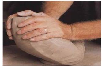
2. Proses seperti di atas dilakukan beberapa kali untuk memastikan bahwa keseluruhan tanah liat bercampur secara homogen.
