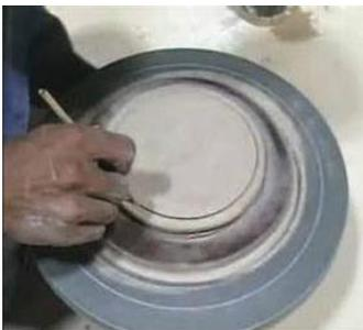
4. Putar *banding wheel* pelan-pelan menggunakan tangan kiri dan potong lempengan tanah liat menjadi bentuk lingkaran untuk alas benda menggunakan jarum. Ambil sisa-sisa potongan dari atas *banding wheel*.
