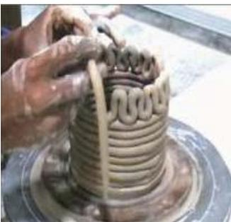
10. Buatlah pilinan tanah liat kemudian satukan di atas pilinan yang telah dirangkai dengan bentuk yang bervariasi, tekan agar sambungan pilinan menjadi kuat. Buatlah bentuk yang bervariasi untuk menambah keindahan benda yang dibuat.
