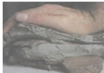
5. Lakukan pengulian dua tanah liat yang berbeda warna tersebut secara berulang-ulang hingga warna tersebut secara berulang-ulang hingga tercampur merata, seperti ditunjukkan pada bagian irisan selama pengulian
