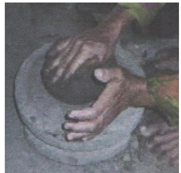
2. Tanah liat tersebut dipukul-pukul menggunakan anvil yang biasanya terbuat dari batu untuk membuat bagian dasar benda sekaligus melebarkan dan memadatkan badan benda keramik.
