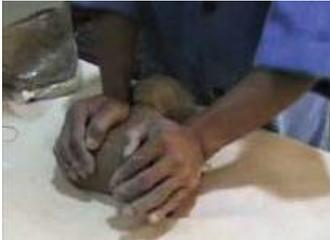
2. Ulin tanah liat tersebut di atas meja pengulian hingga benar-benar homogen dan bebas dari gelembung udara, lakukan juga dengan pengirisan (*wedging*).
