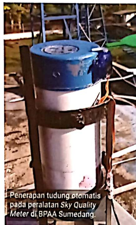
Untuk pengembangan selanjutnya, komponen motor servo perlu digantikan dengan komponen motor servo yang anti-air (*waterproof*) mengingat posisi motor servo berada di luar ruangan dan konektor motor servo dengan pengendali perlu diganti dengan konektor yang anti-air. ■
