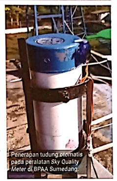
Untuk pengembangan selanjutnya, komponen motor servo perlu digantikan dengan komponen motor servo yang anti-air (waterproof) mengingat posisi motor servo berada di luar ruangan dan konektor motor servo dengan pengendali perlu diganti dengan konektor yang anti-air.
