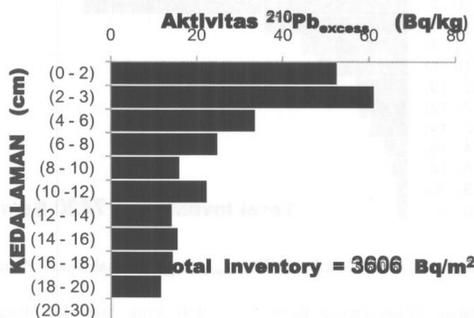
Gambar 7. Profil distribusi <sup>210</sup>Pb<sub>excess</sub> (B) di lapisan tanah Perkebunan Karet - Rumpin
