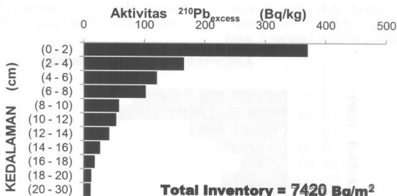
Gambar 6. Profil distribusi <sup>210</sup>Pb<sub>excess</sub> di lapisan tanah Hutan Pinus
