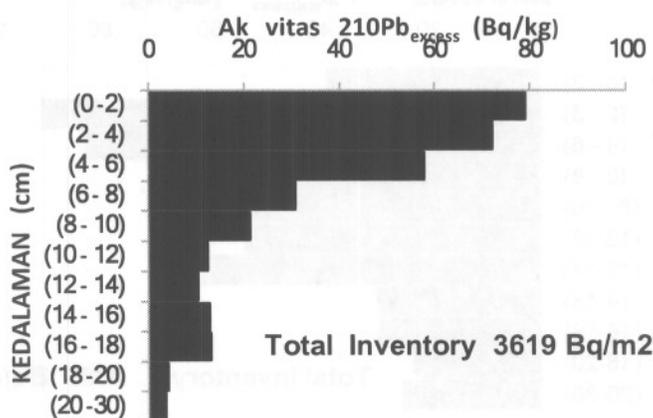
Gambar 5. Profil distribusi <sup>210</sup>Pb<sub>ex</sub> di lapisan tanah Perkebunan teh – Cipelang – Cijeruk
