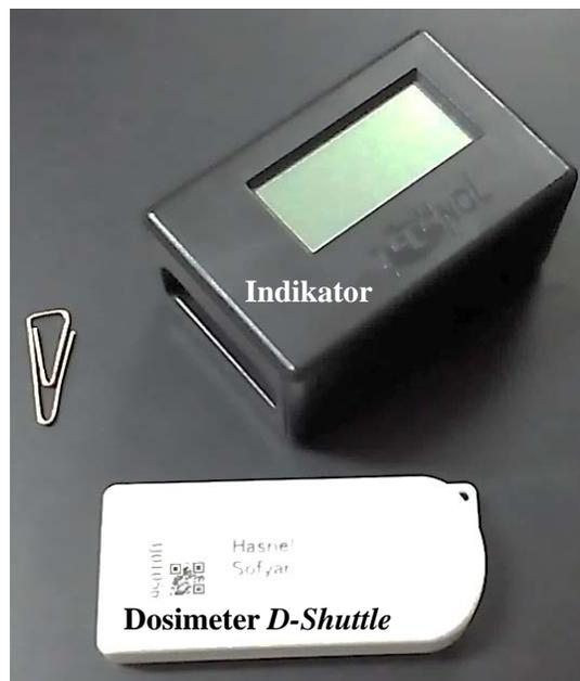
Gambar 4. Dosimeter elektronik perorangan *D-Shuttle*.
