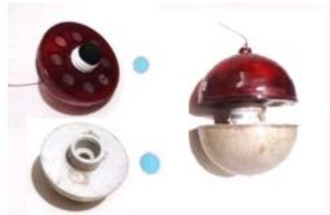
Gambar 2. CR-39 dalam Sistem deteksi Radon dan Thoron
