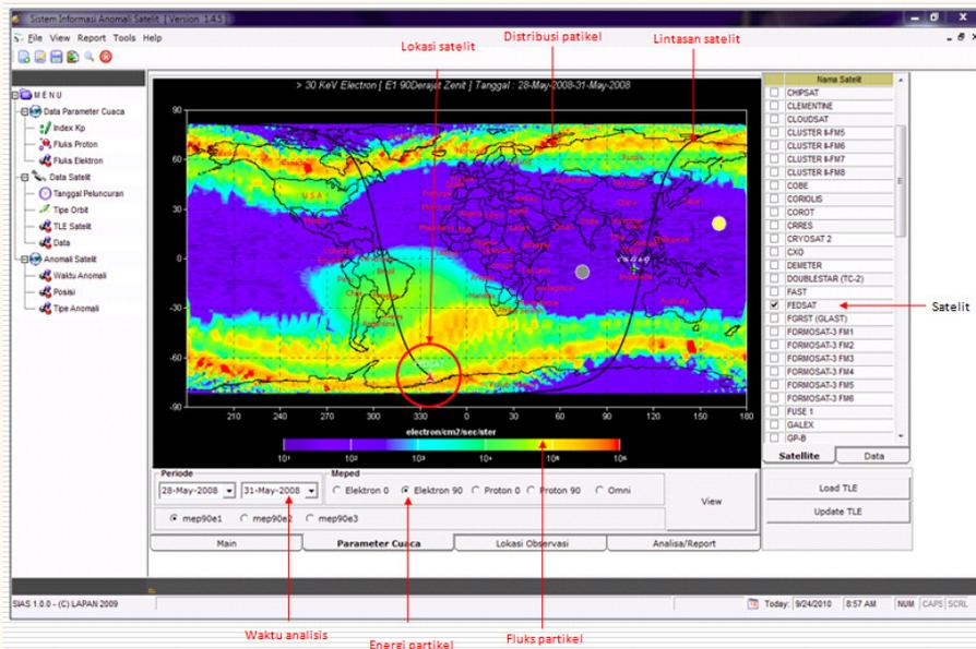
**Gambar 2.** Tampilan program pengembangan perangkat Sistem Informasi Anomali Satelit (SIAS) untuk peringatan dini gangguan operasional satelit.
