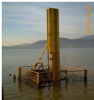
Gambar 3. Alat pengukur tinggi muka air di Danau Towuti .Foto: Nasution
