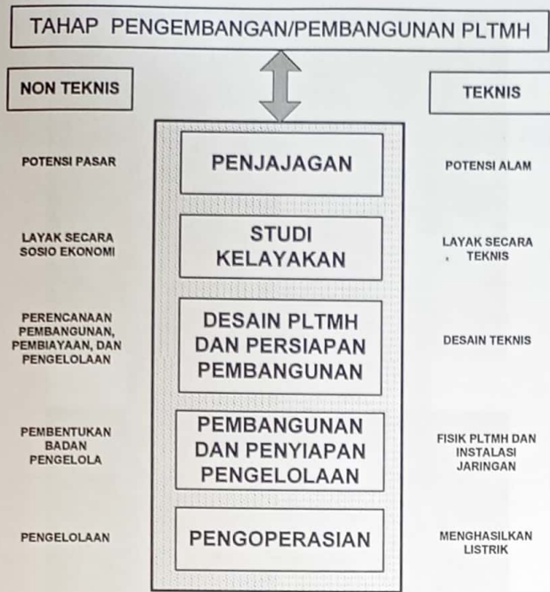
Gambar 3. Diagram tahapan pembangunan pembangkit listrik tenaga mikrohidro.
