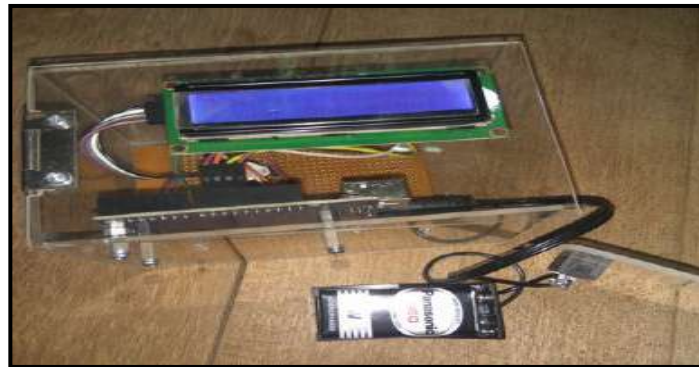
Gambar 6. Pengujian Arduino Uno dengan supply baterai
