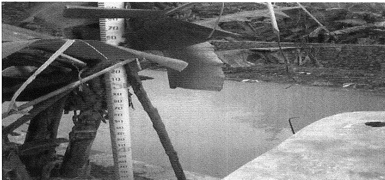
Sumber: Dokumentasi Tim Peneliti PPK LIPI 2013 Gambar 6.6 Alat Pengukur Ketinggian Air Sungai Tikung di DAS Beringin
