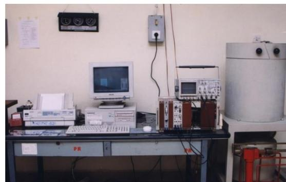
Gambar 3. Spektrometer gamma dengan detektor HPGe model GEM-25185 buatan Ortec
