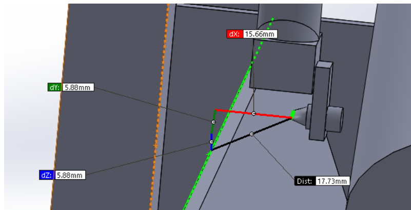
Gambar 8. Jarak antara mulut nozzle dengan dinding wadah Dengan kecepatan ( v ) dari persamaan (9), tekanan yang dibutuhkan didapatkan dengan persamaan (10) dari hukum Bernoulli.
