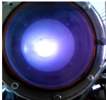
Gambar 4. Lucutan busur plasma yang terjadi di dalam sistem elektrode generator plasma dan diamati pada salah satu ujung bejana generator plasma.
