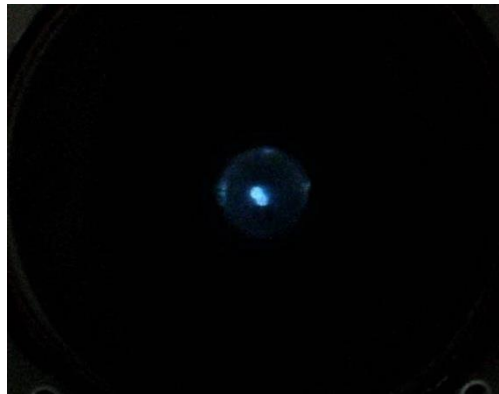
Gambar 2. Spot plasma yang terjadi pada permukaan katode sistem elektrode ignitor yang diamati dari salah satu ujung bejana generator plasma di depan sistem elektrode ignitor.
