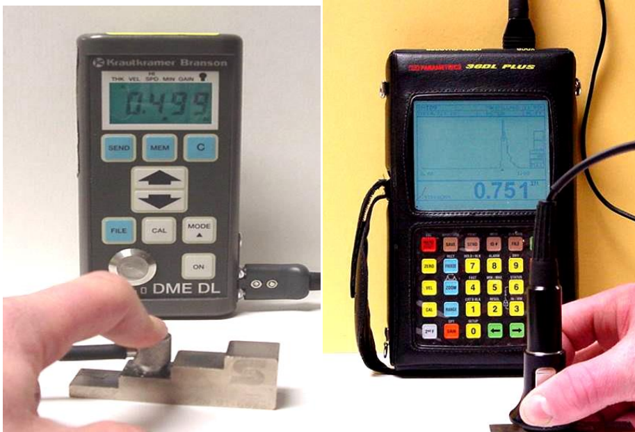
Gambar 8. Proses kalibrasi ultrasonik tes
