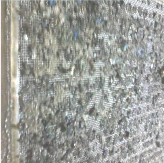
**Gambar 5:** Ram filter mekanik dalam keadaan kotor.
