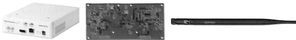
Gambar 8. USRP N210 (kiri), daughterboard RFX900 (tengah), dan antenna 824-960 MHz (kanan). (Sumber: http://www.ettus.com )
